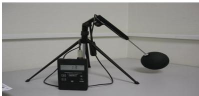
Рис.10.1. Портативный термогигрометр ИВТМ-7КЗ с преобразователем ИПВТ-03М-09
