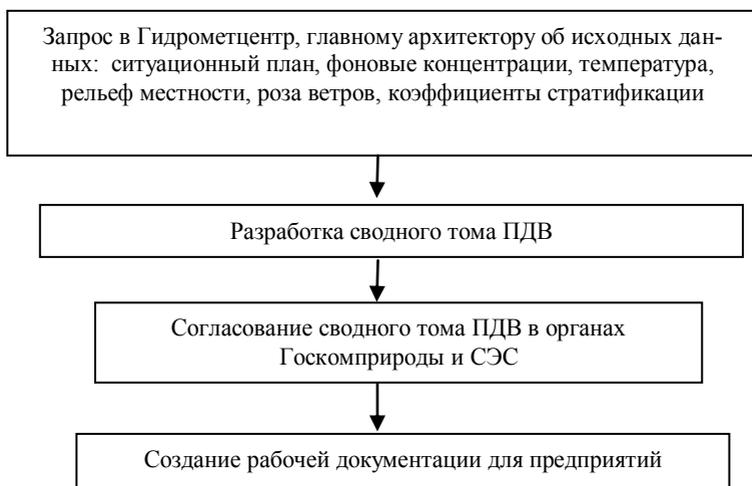
Рис. 4.2. Схема последовательности работ по созданию норм ПДВ
