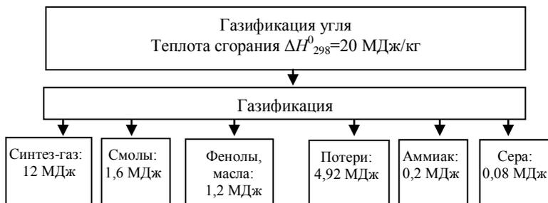
Рис. 1.3. Тепловой баланс газификации угля
