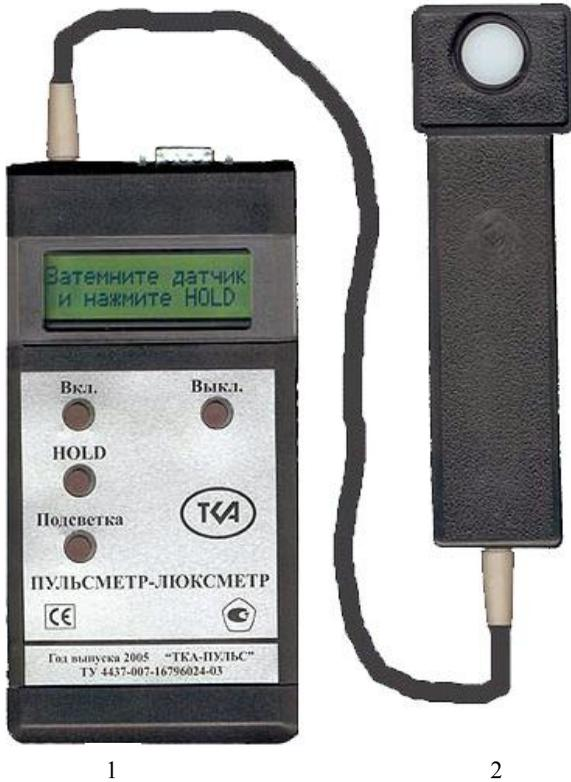
Рис. 4.5. Внешний вид прибора: 1 - блок обработки сигналов, 2 -фотометрическая головка.
