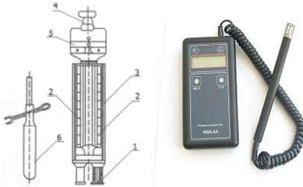
Рис. 1.1 Аспирационный психрометр и термогигрометр:
