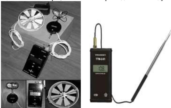
Рис. 1.2 Анемометр цифровой переносной и термоанемометр
