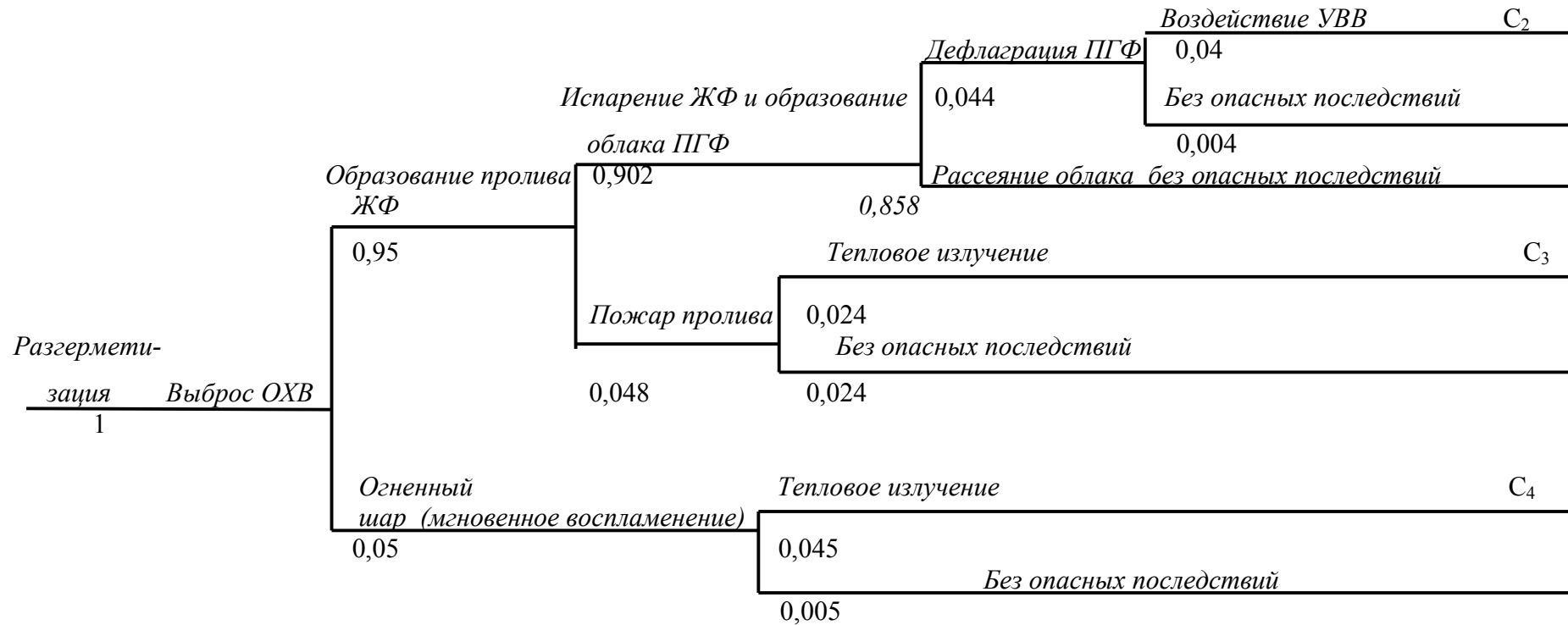
Рисунок А.6 - «Дерево событий» при аварии при полной разгерметизации технологического оборудования (К-1, Е-1а)
