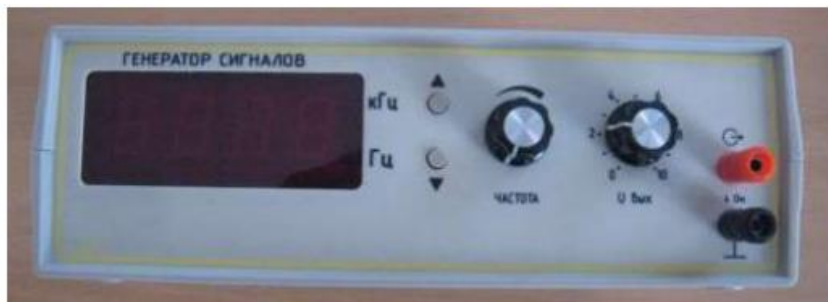
Рис. 5.5. Генератор электрического сигнала
